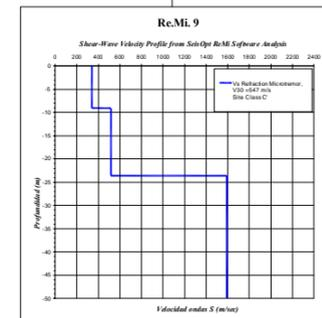
Perfil sísmico para la detección de la velocidad sísmica de las ondas S y reconstrucción geológica del subsuelo
