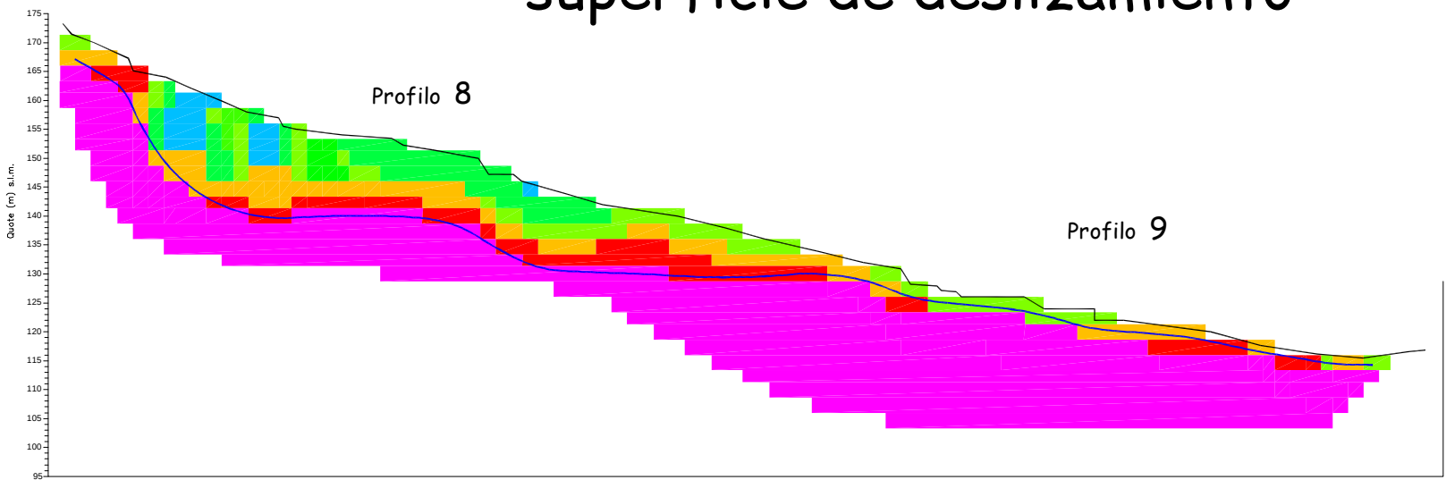
Reconstrucción de la geometría de la superficie de deslizamiento
